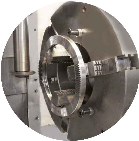
~ Sgrossatura denti ~ Teeth roughing
